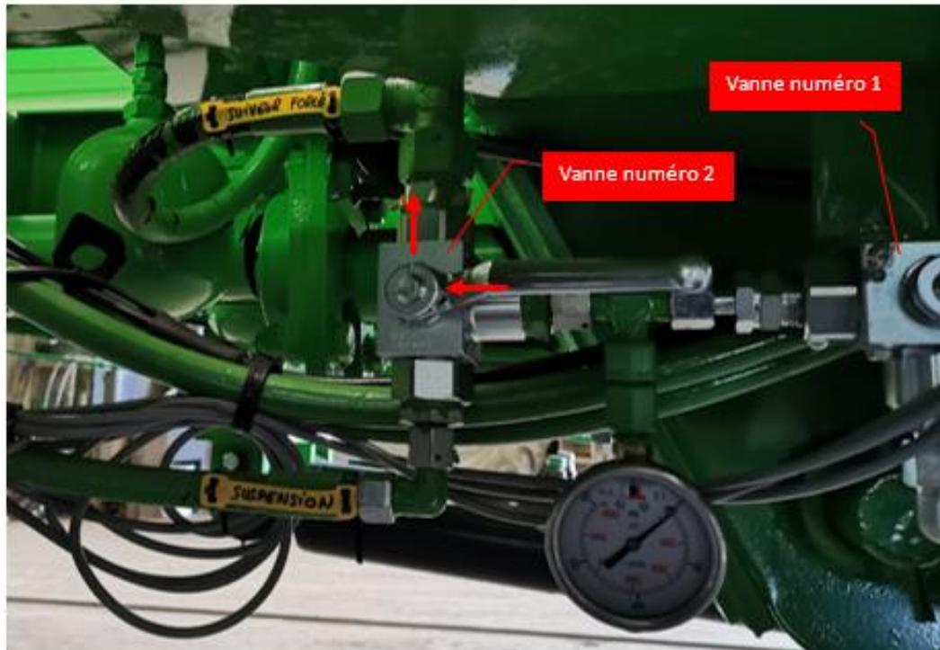
Figure 4 Vanne numéro 2 en position suiveur forcé
