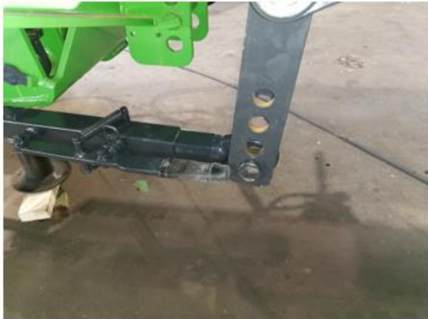
*Figure 8 Barre de liaison reliée au balancier*
