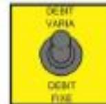
Lorsque la commande du pupitre est sur fixe, le système est compatible avec un circuit hydraulique générateur de type centre ouvert.
