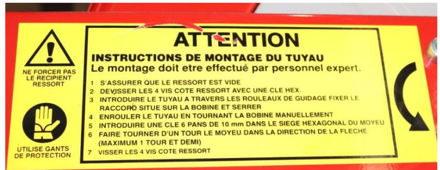
N'effectuez aucune opération d'entretien quand le ressort de l'équipement est en tension ou quand la pression est présente dans le tuyau de connexion. On recommande de décharger la pression résiduelle dans le tuyau et de placer le tuyau en position initiale (flexible enroulé).
