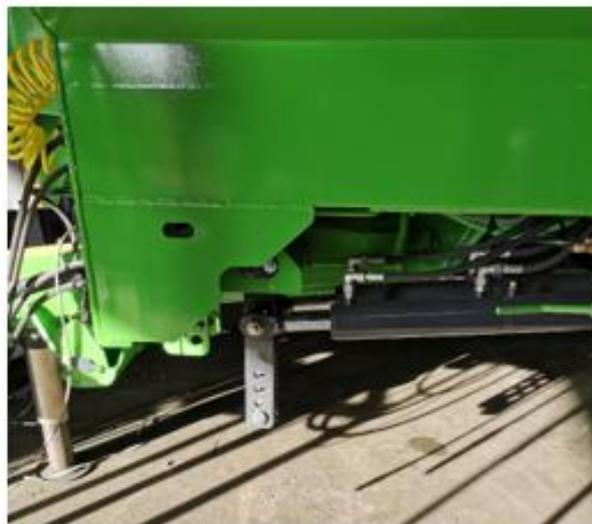
Figure 7 balancier suiveur forcé verticale
