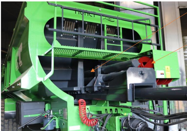
Le front poussant se caractérise par un groupe bélière à l'avant du véhicule. Celui se déploie à l'intérieur de la caisse et vient pousser les céréales ou autres récoltes. Le déploiement des flexibles hydrauliques de ce bélière est assurée par un enrouleur.
