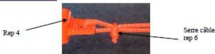
Assurez-vous de manière régulière que le câble de frein est tendu, vérifier le serrage des serre-câbles de tout le système de freinage. En cas de dégradation du câble de rupture rep1 ou du câble de frein rep6 procéder à la mise en place d'un nouveau câble (le câble de rupture est à changer tous les 3 mois tandis que le câble de frein est à changer tous les 2 ans).
