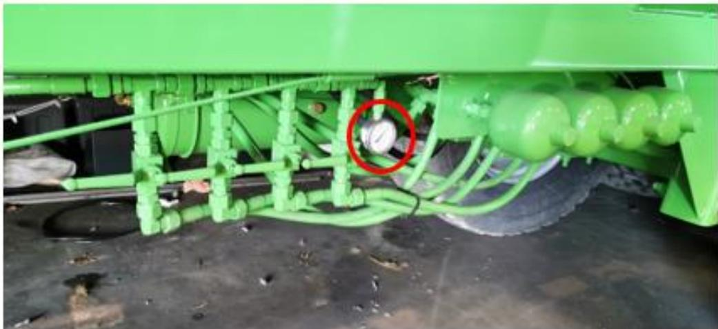
*Figure 10 Manomètre suiveur forcé*
