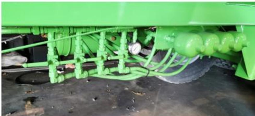
Figure 5 Vannes 1/4 de tour des suiveurs forcés en position fermée
